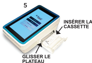
Ajouter quatre (4) gouttes de l'échantillon dans chaque puits de la cassette de test en pressant le tube.
